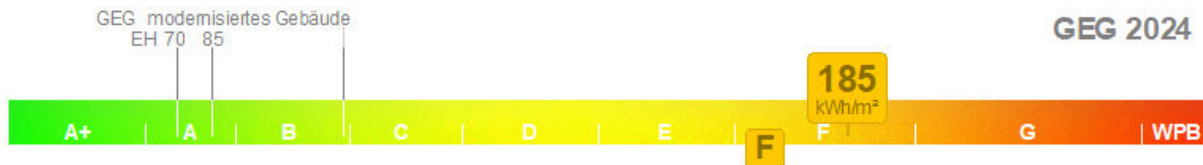
Abbildung 25: Primärenergiebedarf des betrachteten MFH nach DIN V 18599
