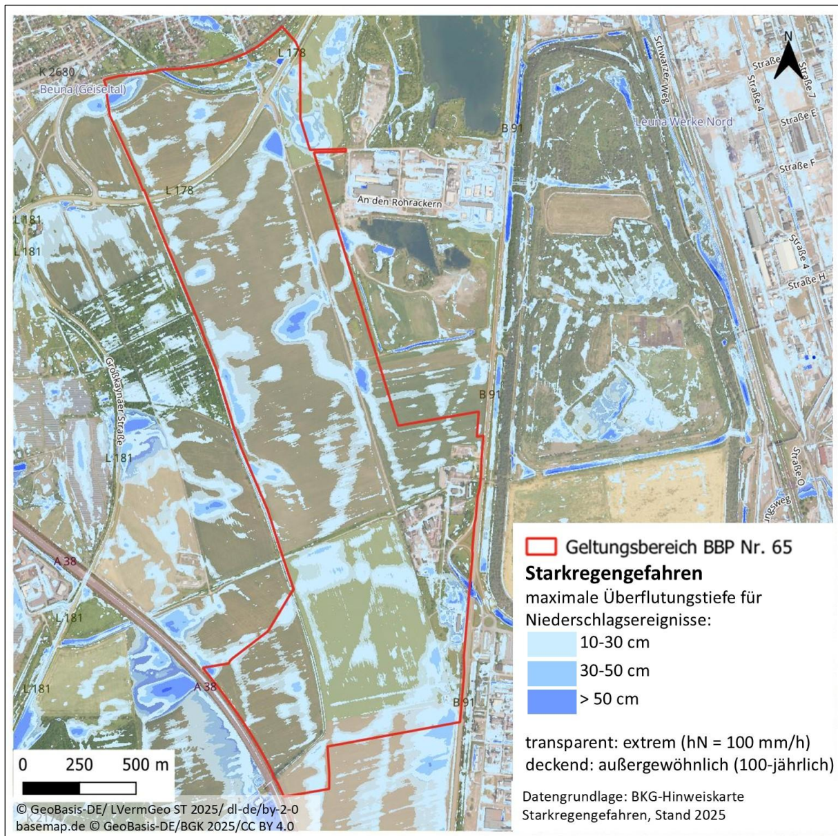
Abbildung 4.8: Überflutungstiefe und Fließrichtung bei Starkregenereignissen im Plangebiet
